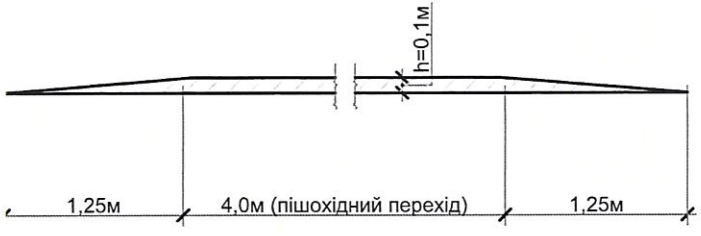
Схема підвищеного пішохідного переходу (трапецеподібний)
